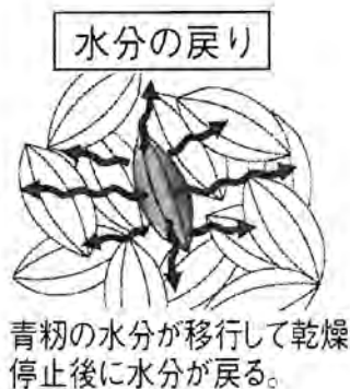
図2. 余熱乾燥と水分の戻り(模式図)
